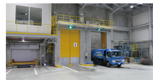
②プラットフォーム 燃やせるごみは、計量棟からプラットフォームに運びこまれ、ごみピットに投入されます。
