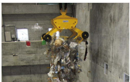
⑥ごみクレーン 大きな爪でごみをつかんで持ち上げ、バケットを開きごみを投下します。これを繰り返して生ごみや紙、プラスチックなど、ごみの偏りがなくなるように混ぜ、均一に燃やせるようにします。
